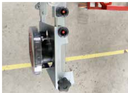
Diese elektrischen Sauger können durch ihre Moosgummi-Sauglippe nicht nur Glas ansaugen
